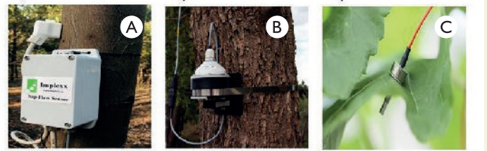
Figura 1: Sensores del estado hídrico de la planta: A) Sensor de flujo de savia; B) dendrómetro; C) Sensor de presión de turgor de hoja
