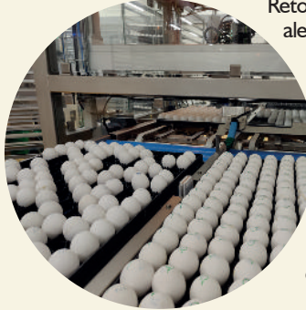
Figura 3. SORTER: clasificación de los huevos fértiles según el género de los embriones.
